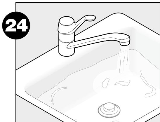
Coloque el tapón en la abertura del fregadero. Llene el fregadero con agua y luego verifique que no haya fugas.
