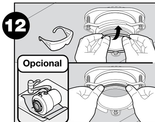
Coloque un peso, por ejemplo el triturador, sobre la brida del fregadero para mantenerla en su lugar. Utilice una toalla para evitar que se raye el fregadero. Abra el anillo de cierre y presione firmemente hasta que se coloque en el lugar.
