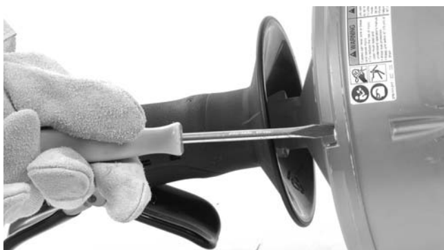
Figure 13 – Desserer les 4 vis de tambour externe de trois tours, sans les enlever
