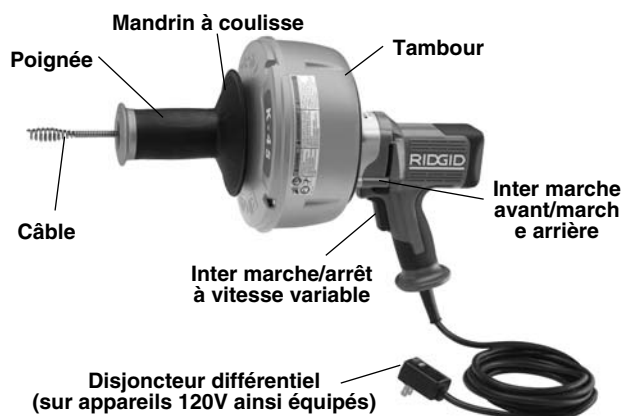
Figure 1 – Dégorgeoir K-45 avec mandrin à coulisse
