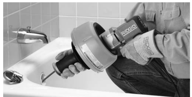
Figura 9 – Acerque la limpiadora al desagüe para ayudar a empujar el cable
