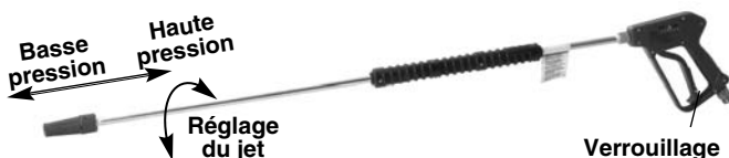
Figure 17 – Réglages du pistolet de lavage
