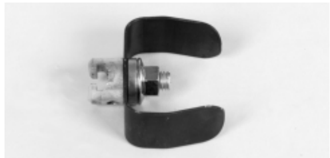
Figura 4 – Cortadora a cuchilla en "C", modelo T-205: se usa en general para zafar los materiales adheridos a los costados del desagüe
