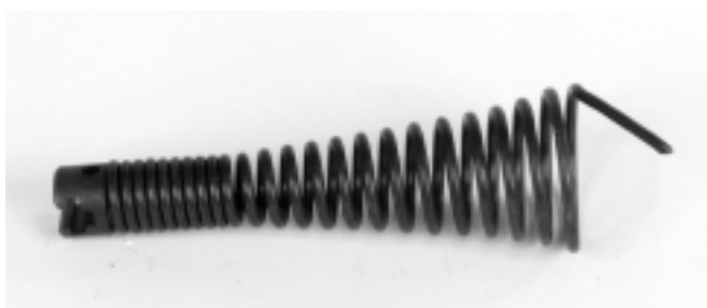
Figura 2 – Barrena de embudo T- 202: se usa para explorar y romper una obstrucción o para traer muestras a la superficie que ayuden a determinar el tipo de herramienta que debe emplearse
