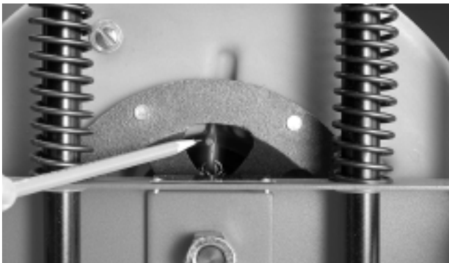
Figure 11 – Tourner le tambour pour accéder à la broche de verrouillage.
