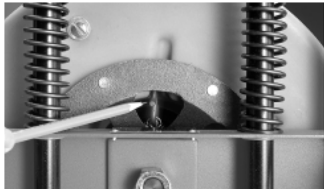
Figura 11 – Gire el tambor para que el pasador de desenganche sea fácilmente accesible.
