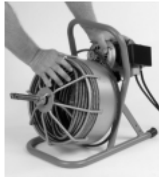
Figura 9 – Empuje sobre el motor para soltar la tensión del resorte sobre la correa
