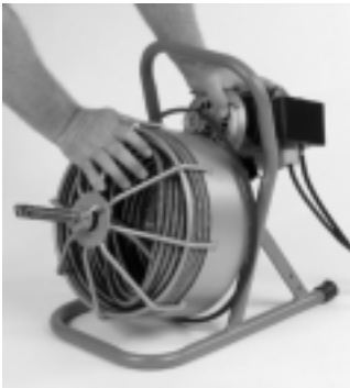
Figure 9 – Appuyer sur le moteur pour soulager la tension de la courroie.
