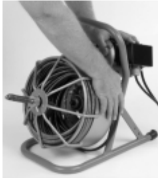
Figure 10 – Une fois la tension soulagée, retirer la courroie du tambour.
