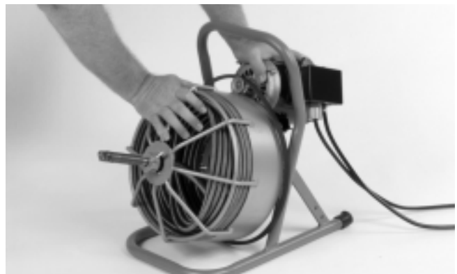
Figure 5 – Appuyez sur le moteur et enflez la courroie sur le tambour.
