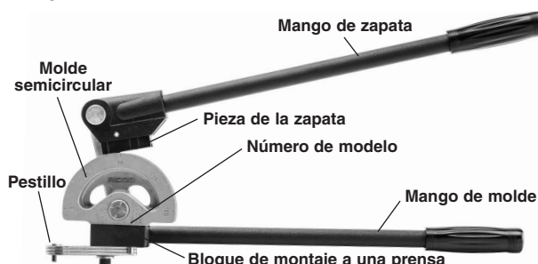
Figura 1 – Dobladora de la serie 300 para plomería
