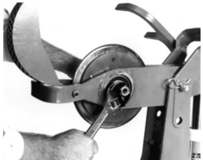
Figure 11 – Retraire de l'écrou de fixation
