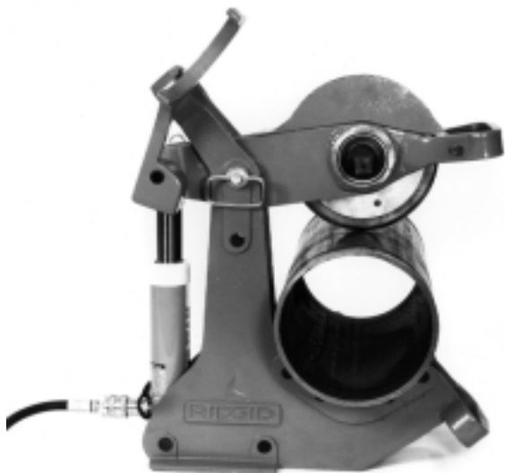
Figure 8 – Positionnement du tuyau sur la tronçonneuse
