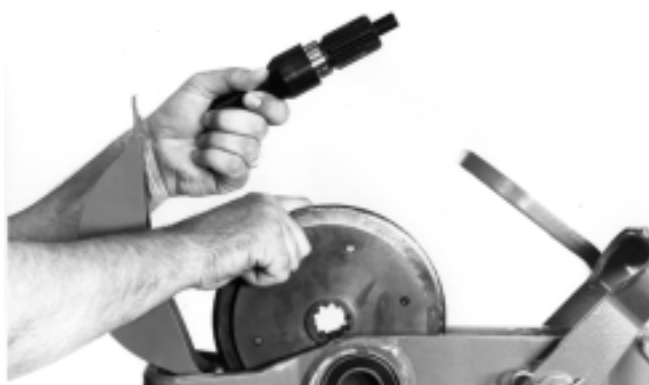
Figure 12 – Retrait du disque de tronçonneuse
