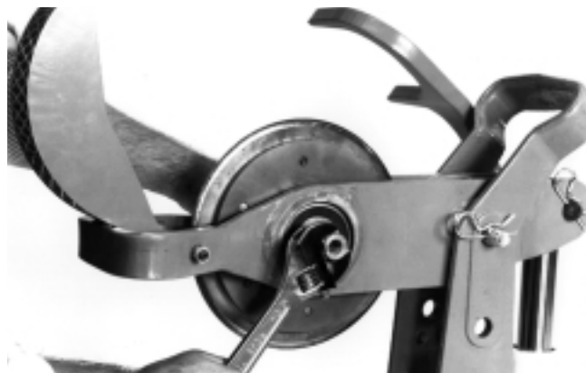
Figura 11 – Extraiga la tuerca de seguridad
