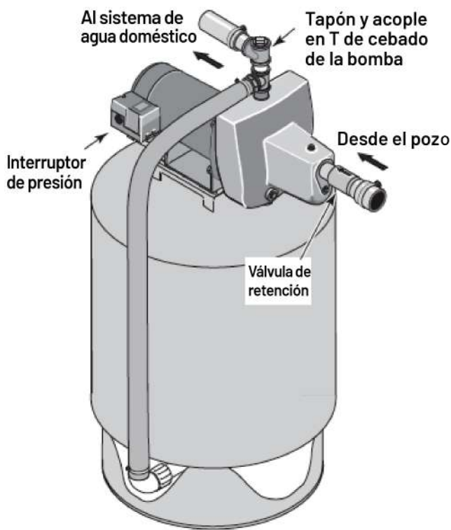
Figura 4: Conexiones del tanque previamente cargado
